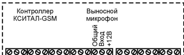
Выносной микрофон следует подключать, руководствуясь инструкцией к микрофону и нижеприведенной таблицей соединений.
