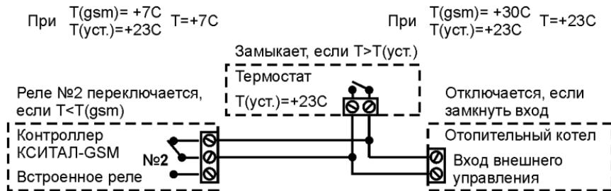
При таком подключении КСИТАЛ-GSM поддерживает дистанционно задаваемое значение температуры (см. раздел "Температура включения реле нагревателя") в помещении ниже установленной на автономном термостате.
