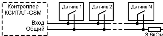
*Резистор является обязательной частью схемы подключения любых датчиков и должен быть размещен внутри или в непосредственной близости от самого дальнего (по проводке) датчика в шлейфе. Это позволяет своевременно узнать об обрывах или замыканиях в проводке (см. раздел "Оповещение по событию").*
