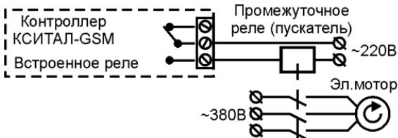
*Если необходимо управлять мощными устройствами, то следует использовать промежуточные реле или пускатели соответствующего типа.*
